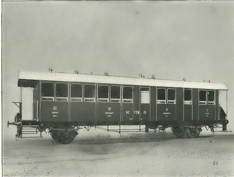
Ein Wagen der Tösstalbahn mit Abteilen zweiter (rechts) und dritter Klasse, produziert von der SWS Schlieren um 1900. Ähnliche Bauarten kamen bei vielen Nahverkehrslinien zum Einsatz. So auch bei der Sihltalbahn, von wo unsere Wagen stammen.
